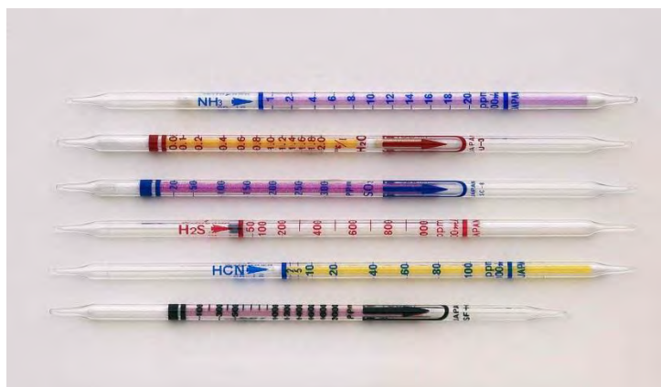
شکل ۸-۱ چند نمونه لوله رنگی برای اندازه گیری غلظت گازهای مختلف
