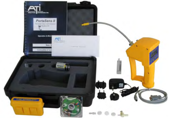
شکل ۸-۹ دستگاه C16 به همراه برخی لوازم جانبی
