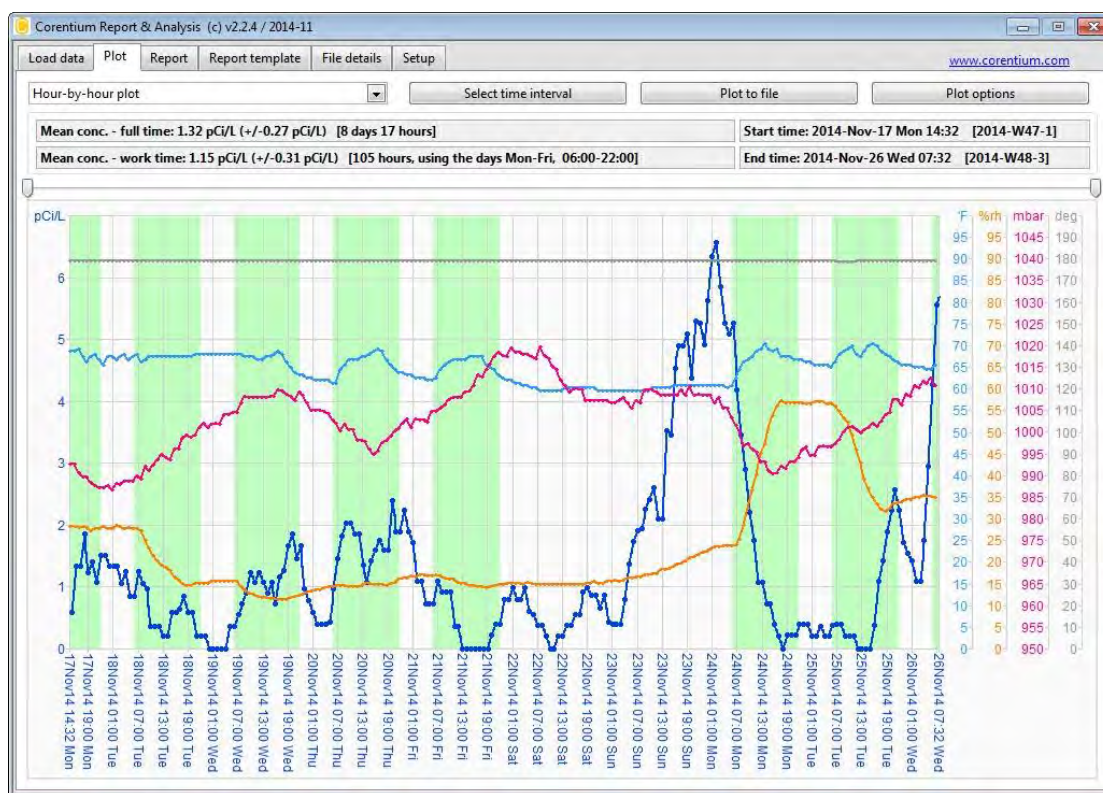
شکل ۹-۲۰ نمونه ای از نمودارهای قابل رسم با نرم افزار CRA مربوط به دستگاه Corentium Pro
