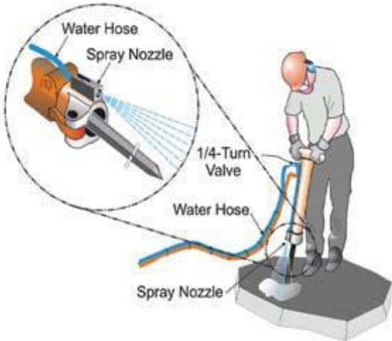
تصویر مته پنوماتیک مجهز به سیستم مرطوب
